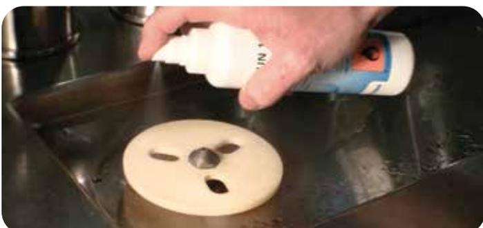
**Schritt 5:** Gitter der Abtropfasse herausnehmen, mit heißem Wasser abspülen. Abtropfasse mit Heißwasser auswaschen, ggf. mit Einwegtuch abtrocknen. Gläserdusche mit Heißwasser abspülen und mit TM 70 desinfizieren.
