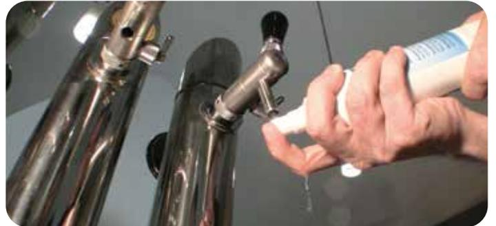
**Schritt 4:** 2-3 Hübe TM 70 Desinfektionsmittel in den Zapfhahn sowie außen auf die Tülle sprühen.
