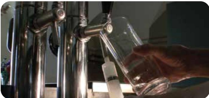
**Schritt 3:** Heißwasser in den Zapfhahn drücken und Eingetrocknetes außen damit abspülen. Spülwasser aus dem Lüftungslloch auffangen und wegschütten.
